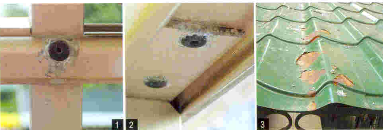
1, 2. Контактная коррозия алюминиевых сплавов (DSCN1659 и DSCN1663).
