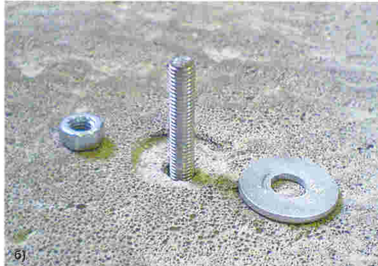
Рис. 1. а) общий вид шпильки \varnothing 8 мм со стороны установки опорной шайбы; б) общий вид опорной зоны блока после испытаний
