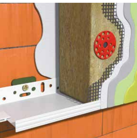
Утепление фасада с тонким штукатурным слоем
